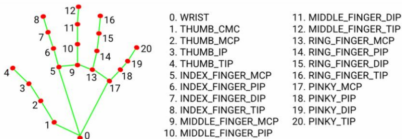
Sl. 1. Prikazuje sistem indeksiranja karakterističnih tačaka šake koji koristi MediaPipe biblioteka. Tačka sa oznakom 0 odgovara ručnom zglobu, dok se ostalih 20 tačaka raspoređuje duž svakog prsta, prateći njihovu anatomsku strukturu od korena do vrha. Izvor: Google Developers, MediaPipe Hands: Hand Landmarker.
