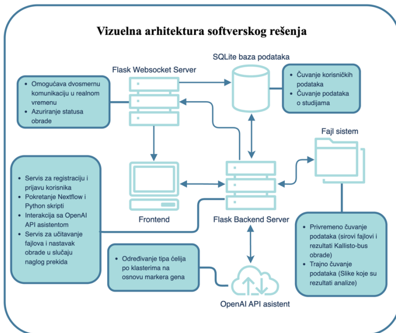
DIJAGRAM 3. ARHITEKTURA SOFTVERSKOG REŠENJA ZA ANALIZU I SKLADIŠTENJE PODATAKA DOBIJENIH IZ EKSPERIMENTA JEDNOĆELIJSKE RNK
